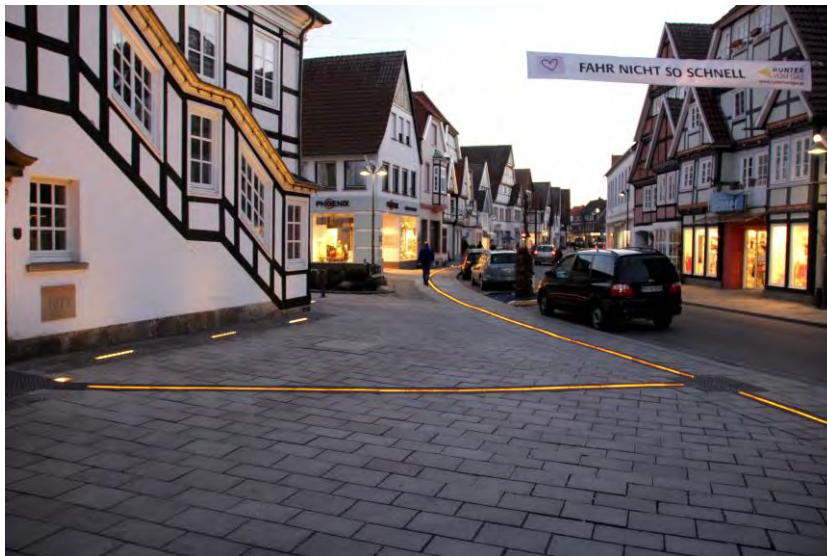
Bild 4. LED-Leitstreifen im Gehweg der Rietberger Rathausstraße bei Dämmerung / Linear guidance system along Rathausstrasse in Rietberg built using the new LED-paving-blocks
